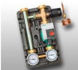
Насосные группы D-MTR (с ограничением температуры обратной линии, термостат 35-65 °С)
