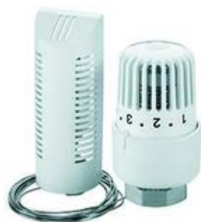
Термостатические головки RoTherm II SRH с резьбовым соединением М 30x1,5, с выносным датчиком, с установкой нуля
