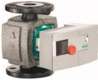
Циркуляционный насос с мокрым ротором, с резьбовым или фланцевым соединением, электронно-коммутируемым мотором и автоматической регулировкой мощности.
